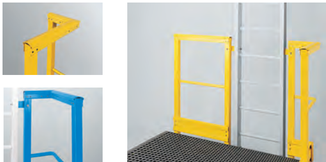
Corrimano ergonomico: profilo arrotondato per evitare la ritenzione di sporcizia e facilitare la presa. Ref. B703B Lunghezza 6 metri. Colori: giallo, blu o grigio.
